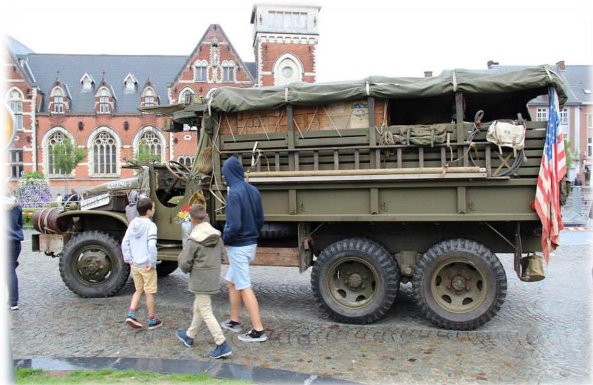
Camion GMC. CCKW (C : le véhicule a été conçu en 1941, C : la cabine est de type conventionnel, K : toutes les roues sont motrices, W : un train de roues doubles à l'arrière)
