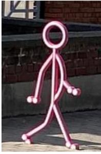
Acier S235JR - Tubes de 42 mm - Bande rétro-réfléchissante 20 mm sur 2 faces Couche polyzinc anticorrosion - Peinture époxy 80 microns cuite au four - Scellement direct avec pattes de scellement Coloris : 5 RAL disponibles RAL 1003 Jaune, RAL 2009 Orange, RAL 3020 Rouge, RAL 5017 Bleu, RAL 4006 Pourpre.
